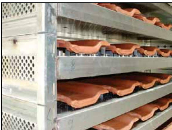
Bild 7: MobilSystem von Rotho- System von Kanal Formlingsträgern /49/
