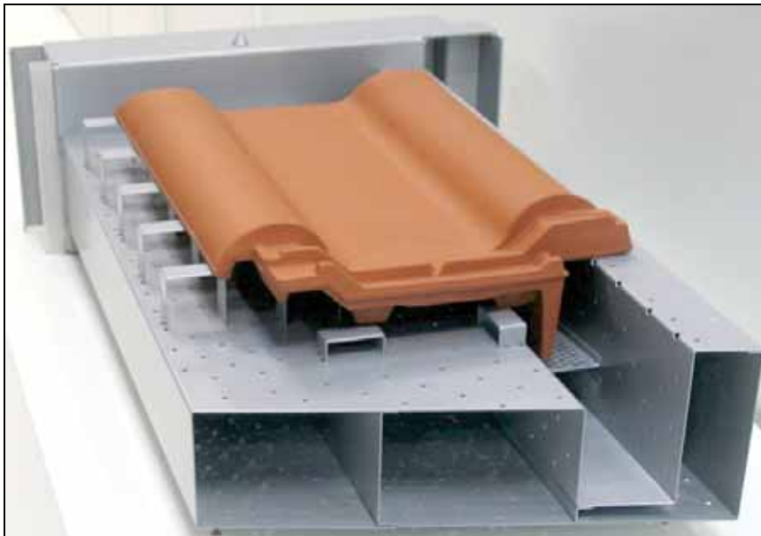
Bild 6: MobilSystem von Rotho- Kanal Formlingsträger für Dachziegel /49/
